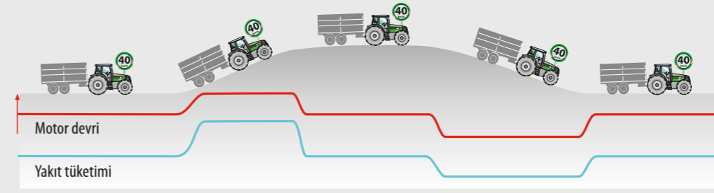
Traktör Yönetim Sistemi - TMS sayesinde tasarruflu sürüş tam otomatik şekilde gerçekleşir
