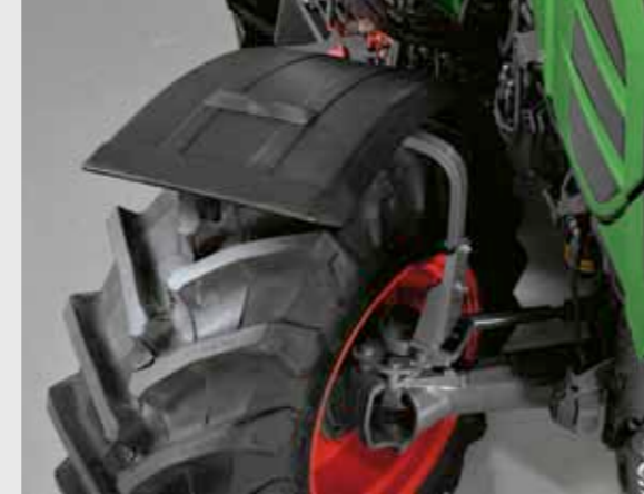
Yanlara dönebilen çamurluklar 200 Vario opsiyonel olarak yanlara dönebilen ön çamurluklar ile donatılabilir. Bu çamurluklar sayesinde azami tekerlek dönüşünü elde eder ve daire dönüş çapınız 3,98 metre olur.
