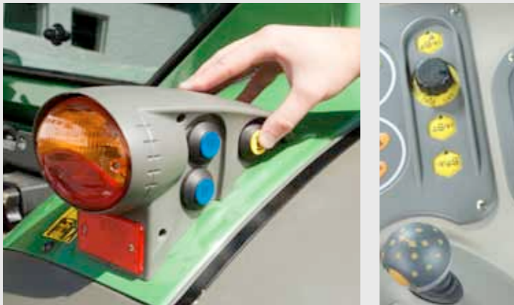
Gereksiz uğraşlardan tasarruf edin - Kuyruk mili için ergonomik ve konforlu kullanım 200 Vario'da arka hidrolik kolların ve arka kuyruk milinin etkinleştirilmesi için harici düğmeler bulunmaktadır. Bu sayede ekipmanları arkaya rahatça bağlar ve gereksiz uğraşlardan tasarruf edersiniz; örneğin sıvı gübre deposunu doldururken.
